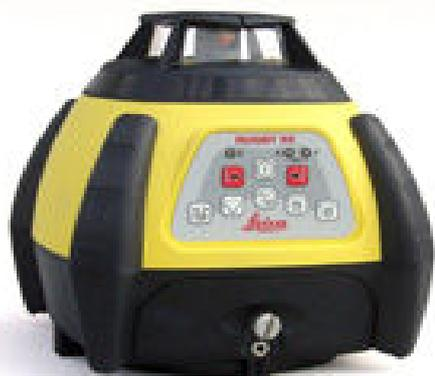
**Livello Elettronico Automatico** a raggio visibile per Piani Orizzontali e Verticali, Squadro, Velocità di Rotazione Selezionabile, Scansione, Allarme automatico di quota, Pendenza manuale, raggio operativo di **150 m**. Completo di ricevitore, stadia in alluminio da 2,5m, treppiede con base elevazione, batterie ricaricabili e valigetta di trasporto.
